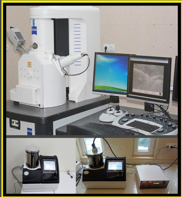
آزمایشگاه مرکزی دانشگاه خوارزمی با در اختیار داشتن دستگاه میکروسکوپ الکترونی روبشی (SEM) با فیلمنان هگزابورید لانتانیم (LaB<sub>6</sub>) از کمپانی (Zeiss) آماده ارائه خدمات به محققین و دانشجویان گرامی می باشد.
